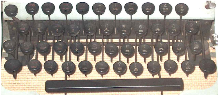
그림 8. 공병우 타자기의 자판. 공병우는 사용자들의 의견과 자신의 경험을 토대로 끊임 없이 자판을 소폭 수정했다. 사진에 보이는 자판 배열은 그 중 하나다. 다만 초성은 오른쪽에, 중성과 종성은 왼쪽에 배열한다는 대원칙은 변함없이 적용되어 왔다. 맨 위의 숫자 줄까지 자모가 배당되어 있는 것이 특징이다. 세종대왕기념관에서 촬영.
