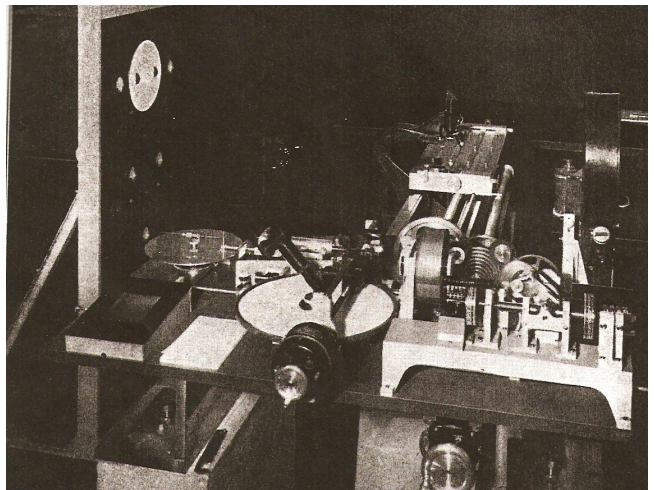
〈그림 7〉 해리슨의 자동 비교측장기. 출처: MIT Tables (주 6 참조).
