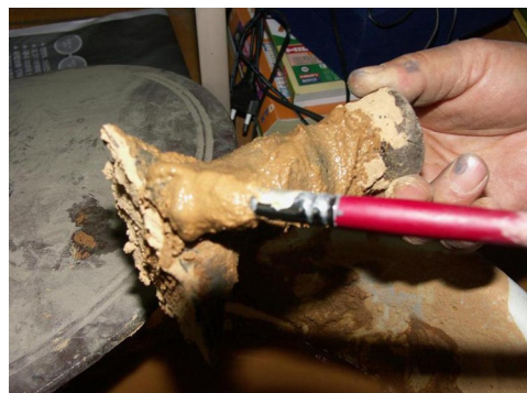
<그림 10> 속 거꾸집 만들기(속 주물토 밀랍활자에 바르기)
